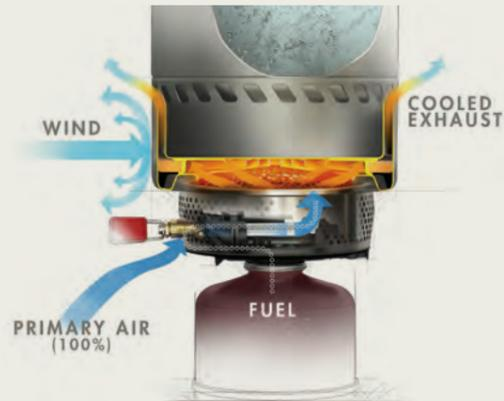
우리는 1차적으로 인입된 공기의 연소 방법을 발명한 것은 아니지만, 가장 먼저 백컨트리 산업에 적용했습니다. 일반적인 연소는, 아래의 공기 (1차 인입 공기)와 함께, 열원과 주변, 뒷 부분에 산소 (2차 공기)가 필요합니다. 100% 일차 인입 공기 연소에는 필요한 공기를 모두 밑에서 끌어 올라, 완전히 밀폐된 불꽃이 가능하게 하여, 연소의 효율을 극적으로 높입니다. 전체적으로 연료를 적게 필요로 하는 장점은, 바람의 영향을 받지 않는 불꽃의 모든 상황에서 신뢰성에 의하여 더욱 증폭되어, 우리의 리액터와 윈드버너 스토브 시스템을 실제 세계에서의 성능에서 타의 추종을 불허합니다.
